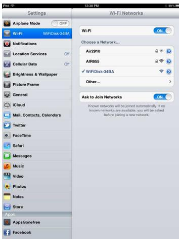
Nach Auswahl von „WiFiDisk –XXXX“ wird ein Häkchen vor der SSID und das WLAN-Logo wird hinter dem Gerätenamen oben links im Display angezeigt.
